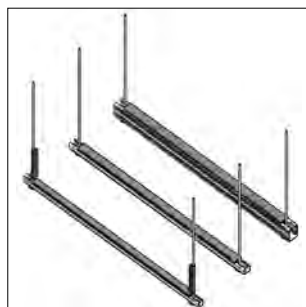
Luchtkanaal ophangelement met geluidsdemping (montagevoorbeeld)
